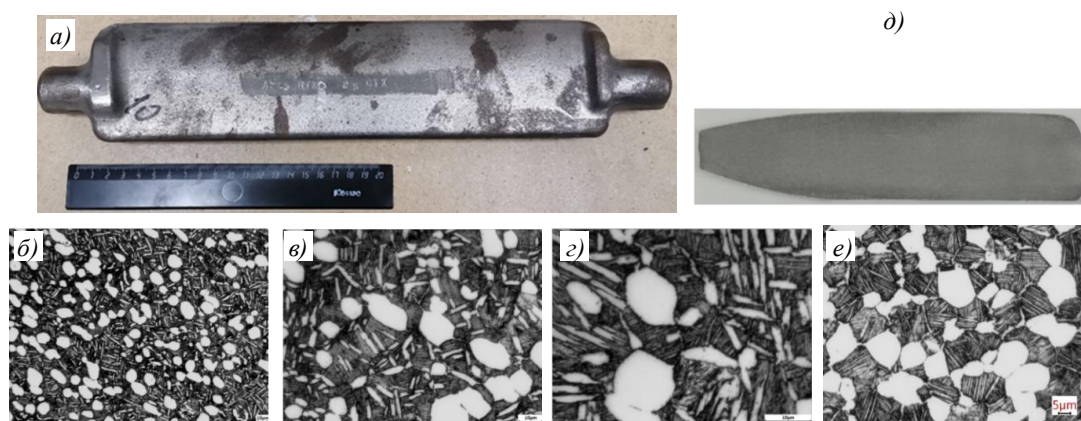
Рис. 15. Внешний вид молотовой штамповки из сплава ВТ46, изготовленной из исходного прутка Ø48 мм (а), типичная микроструктура штамповки при различных увеличениях в поперечном сечении (б–д), макроструктура пера в поперечном сечении (е), микроструктура исходного горячекатаного прутка после двойного отжига в поперечном сечении (е)
