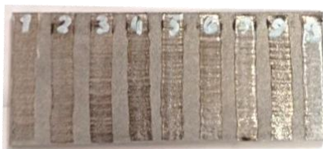
Рис. 3. Внешний вид образца из алюминиевого сплава с нанесенными треками лазерной очистки при различных мощностях излучения
