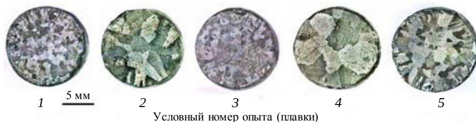
Рис. 2. Макроструктуры поликристаллических отливок образцов (поперечное сечение) из сплава ВЖЛ22, полученных по различным технологическим параметрам равноосной кристаллизации
