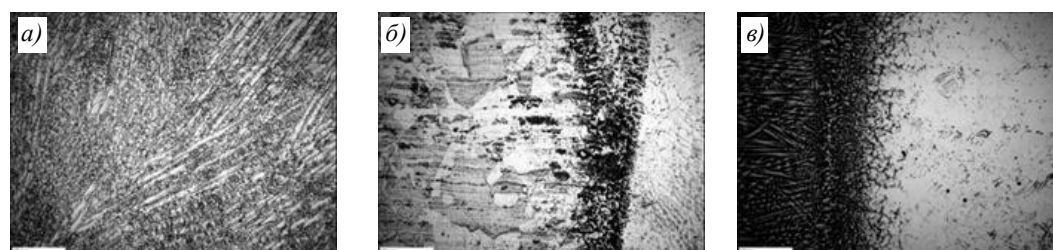
Рис. 35. Микроструктуры ( \times 200 ) образца разноименного сварного соединения KX28M6 + 12X18H10T с двумя подварками: а – зона сварного шва; б – зона термического влияния стали 12X18H10T; в – зона термического влияния сплава KX28M6
