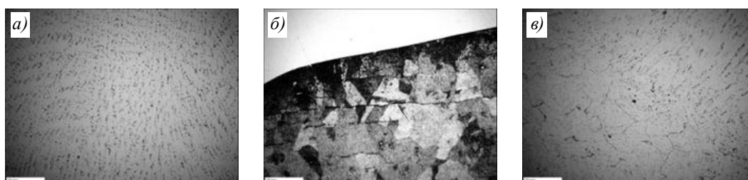
Рис. 32. Микроструктуры ( \times 200 ) образца сварного разноименного соединения ВЖ159-ПС + 12X18N10Т с тремя подварками: а – зона сварного шва; б – зона термического влияния стали 12X18N10Т; в – зона термического влияния сплава ВЖ159-ПС
