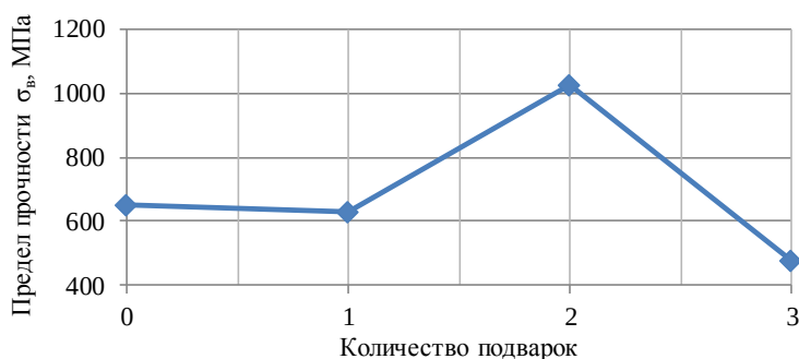
Рис. 43. Влияние количества подварок на механические свойства разноименного сварного соединения KX28M6 + 12X18H10T
