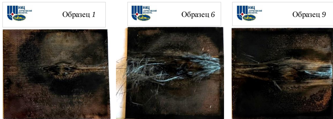
Рис. 6. Образцы углепластика с молниезащитным покрытием марки ВМЗП-3 после испытаний на молниестойкость
