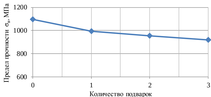
Рис. 39. Влияние количества подварок на механические свойства одноименного сварного соединения X15H5Д4Б + X15H5Д4Б с термической обработкой после сварки
