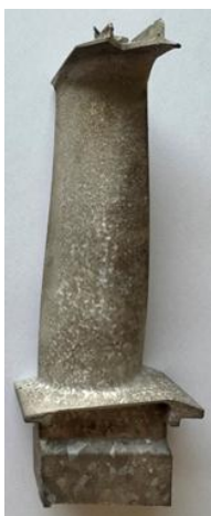
Рис. 10. Поликристаллическая отливка лопатки из сплава ВЖЛ22 после резки и химического травления
