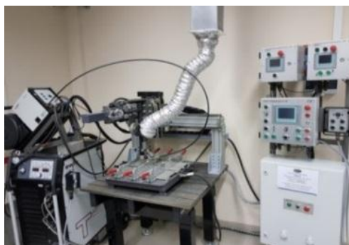
Рис. 2. Технологический комплекс КДС-29 автоматической аргоно-дуговой сварки
