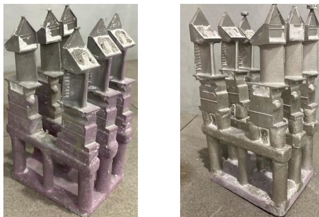
Рис. 13. Блоки отливок рабочих монокристаллических лопаток из сплава ВЖЛ22 с литниковой чашей после удаления керамической оболочки
