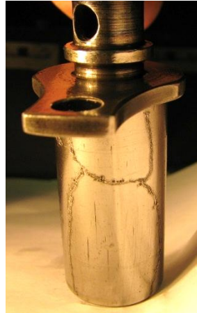
Рис. 9. Цилиндрический контрольный образец с выявленными дефектами
