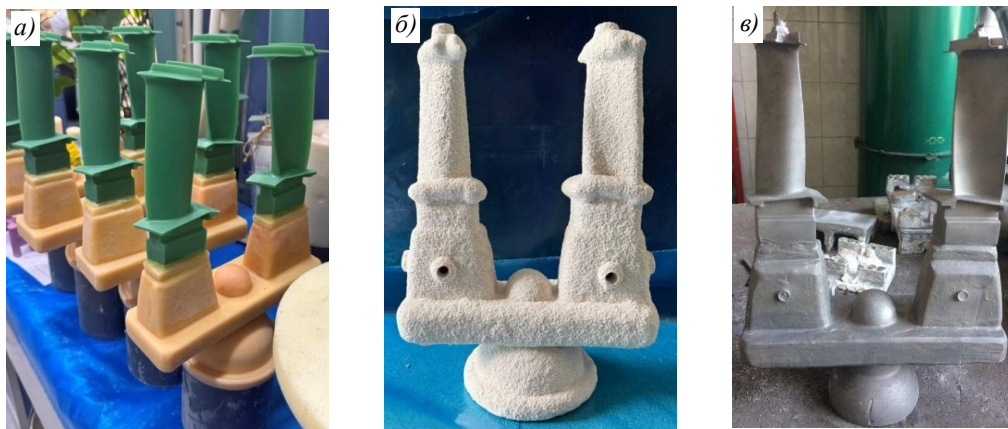
Рис. 9. Модельные блоки рабочих лопаток (а), керамическая форма блока для литья лопаток (б) и блок отливок рабочих лопаток из сплава ВЖЛ22 (в)
