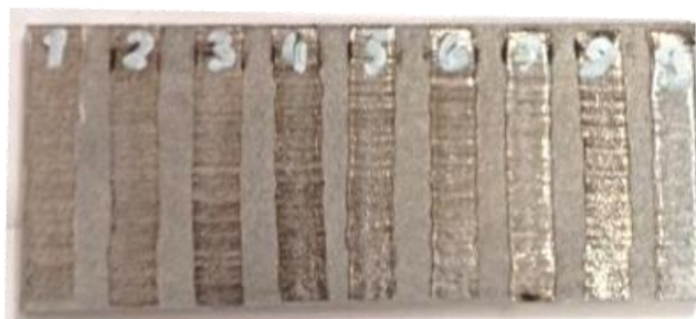
Рис. 3. Внешний вид образца из алюминиевого сплава с нанесенными треками лазерной очистки при различных мощностях излучения
