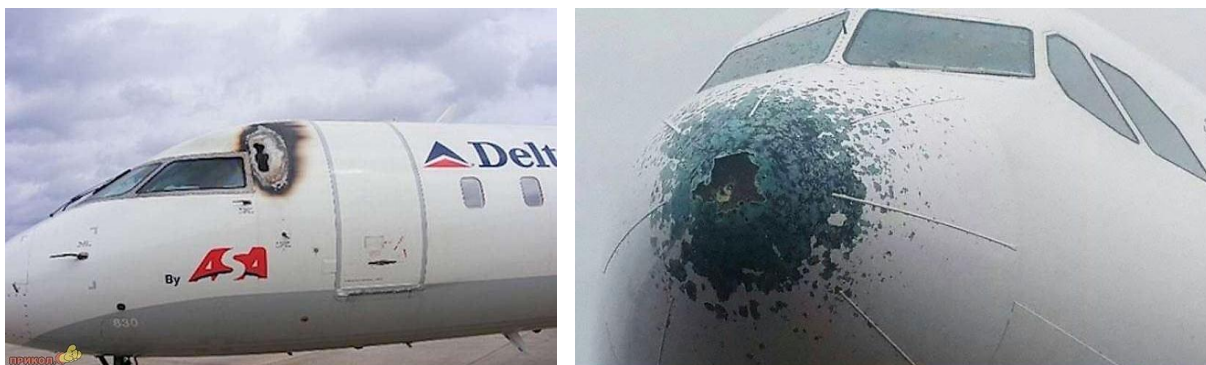
Рис. 1. Результаты ударов молнией в конструкции самолета [7]
