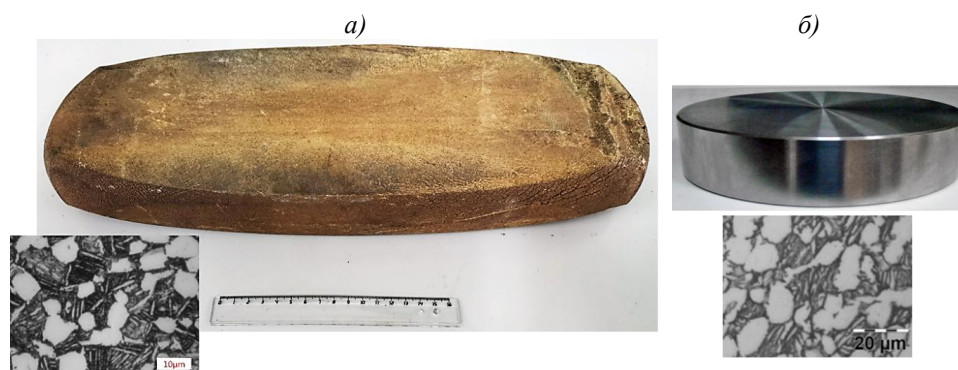
Рис. 7. Внешний вид и микроструктура материала поковок из нового сплава (а) и сплава ВТЗ-1 (б)
