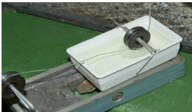
Рис. 5. Устройство для замасливания нитей путем погружения
