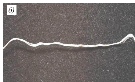
Рис. 7. Внешний вид оксидной нити в исходном состоянии (а) и после обработки замасливателем (б)
