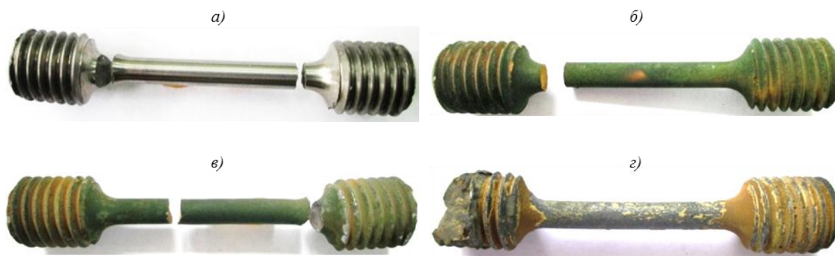
Рис. 9. Вид образцов из Nb–Si композита после испытаний при высокой температуре
