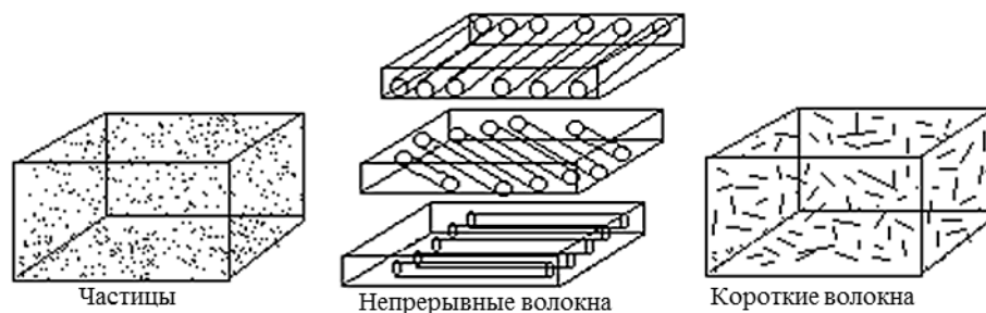
Рис. 1. Схематичное изображение типов металлических композиционных материалов (МКМ)
