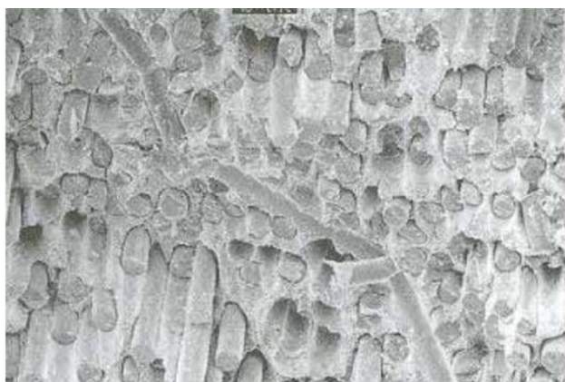
Рис. 3. Неупорядоченные волокна в системе Ti–Al 2 O 3
